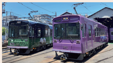
回生ブレーキを導入したモボ2001形2002号車(左)と2001号車(右)
