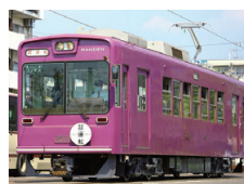
回生ブレーキ化改造された 2001号車
