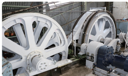
更新したロープウェイの原動滑車
