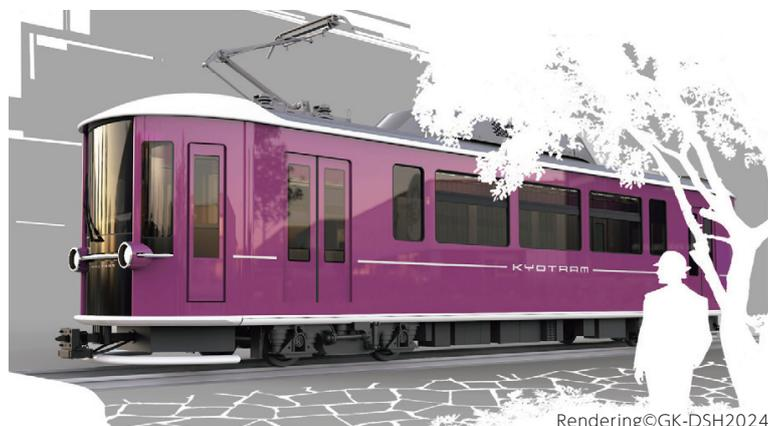
新型車両「KYOTRAM」。VVVFインバータ制御や回生ブレーキにより消費電力量を大幅に削減します。本年度中に1両、以後順次6両を導入予定。「KYOTRAM」導入に備え、2023年度までに回生電力貯蔵装置の設置、VVVF制御の2001形車両2両の回生ブレーキ化改造工事が竣工しています。本年3月25日から、専用SNSでPR活動もスタートしました。
