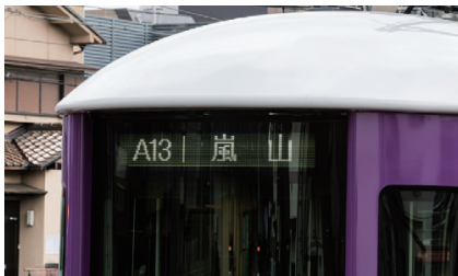
LEDで日英中韓とひらがな、駅ナンバーを表示する行先表示器
