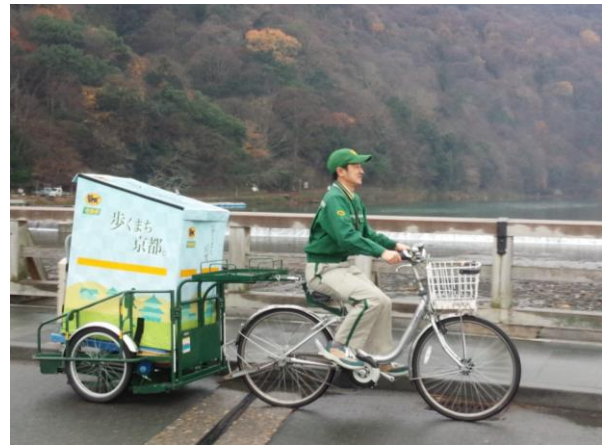
リヤカー付き電動自転車で環境に配慮した集配
